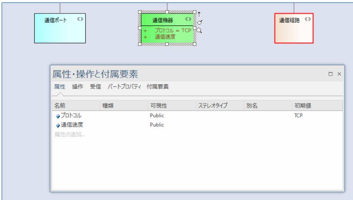
このようにしてタグ付き値を指定して UML プロファイルを作成した例は次のとおりです。プロパティサブウィンドウで、次の画像のように、プロパティ項目の一部として表示されます。この値を変更できます。プロファイルの定義時に boolean 型を指定したタグ付き値はコンボボックスから値を選択できます。
