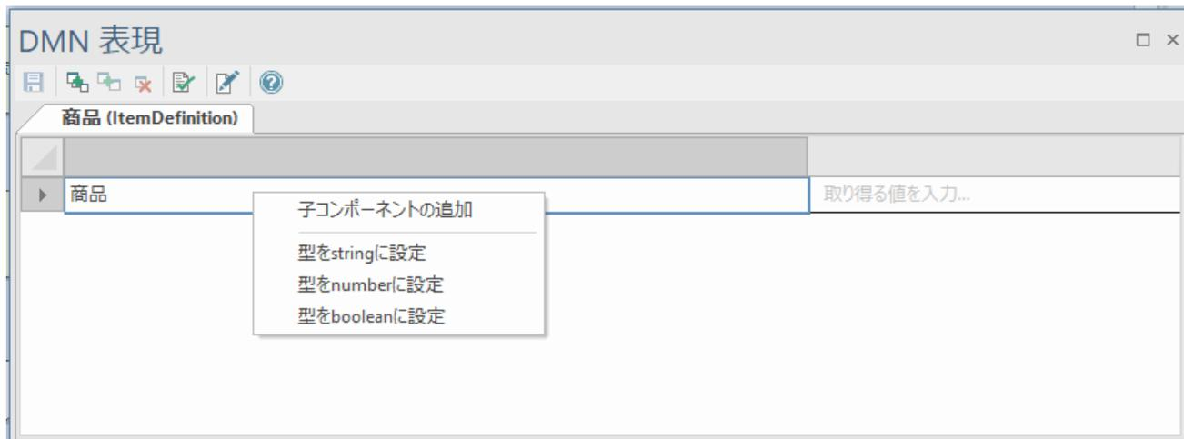
「New Component」の欄が増えますので、クリックして名前を編集し「食品」としてください。また、そのセルを右クリックして、「型を boolean に設定」を選び、真偽値(true/false)とします。
