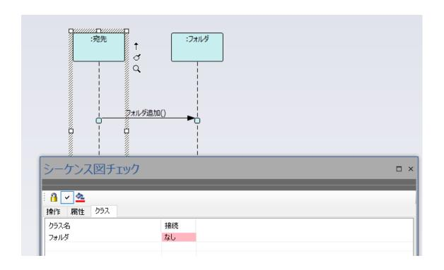
なお、メッセージの戻りを属性に格納する場合に、プロパティ画面の「割当」に入力することで、クラス要素の属性とシーケンス図の整合性も確認できます。下の図では、「属性」 タブに表示される内容で、属性についての整合性を確認しています。
