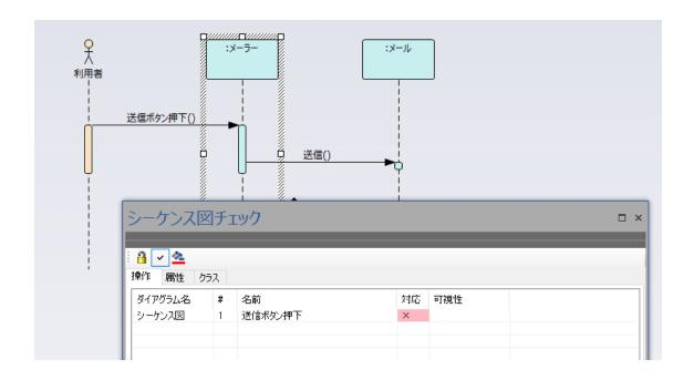
この例では、「対応」の欄が「×」、つまり、クラス図に操作として存在しないことを示しています。この場合に、該当の行をダブルクリックすることで、クラスの操作として追加することができます。
